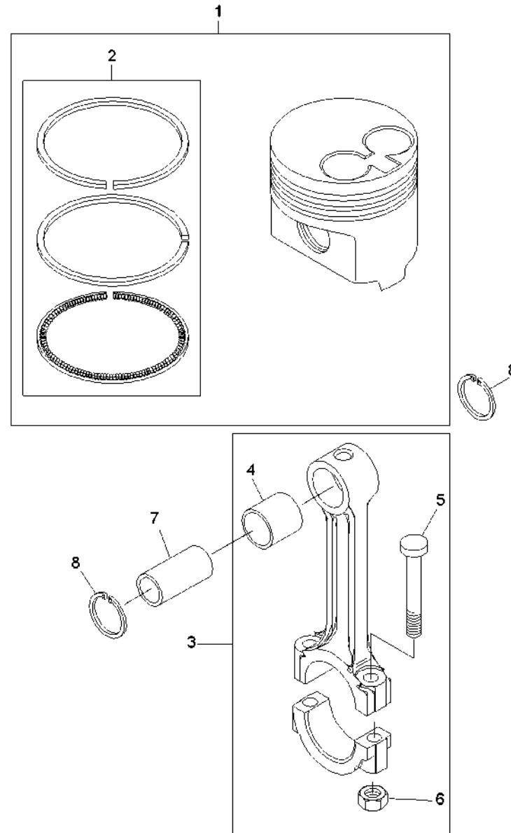
ETS KOLBEN U. RINGE 404D-22
